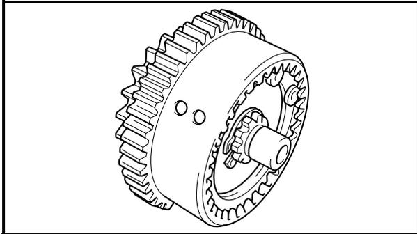
**CHECKING THE TORQUE LIMITER**
