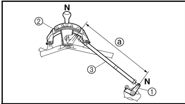
**INSTALLING THE SELECT LEVER UNIT**
